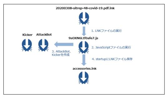
図1 攻撃フロー① (感染トリガーから永続化まで)
