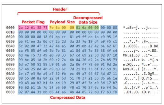
図 18 送受信するペイロードの例(受信時)
